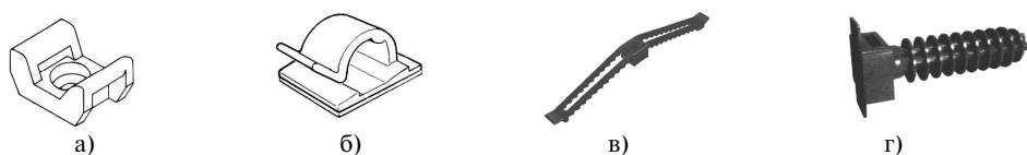
Рис. 172. Элементы крепления одиночных проводов:
