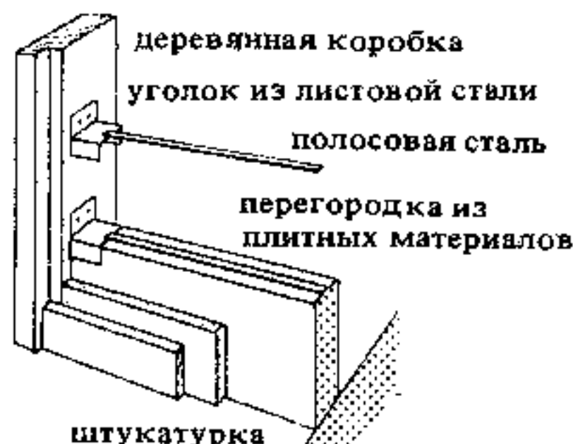
11. Крепление дверной коробки и перегородки
