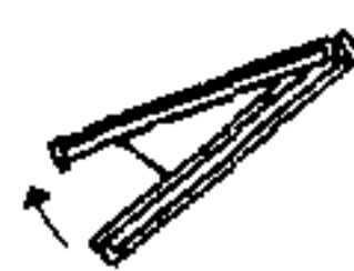
14. Откидные створки для простеиков помещений. Уклон кровли 20–85°
