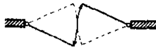
15. Одно- и двустворчатая качающаяся дверь, при необходимости для двустороннего движения
