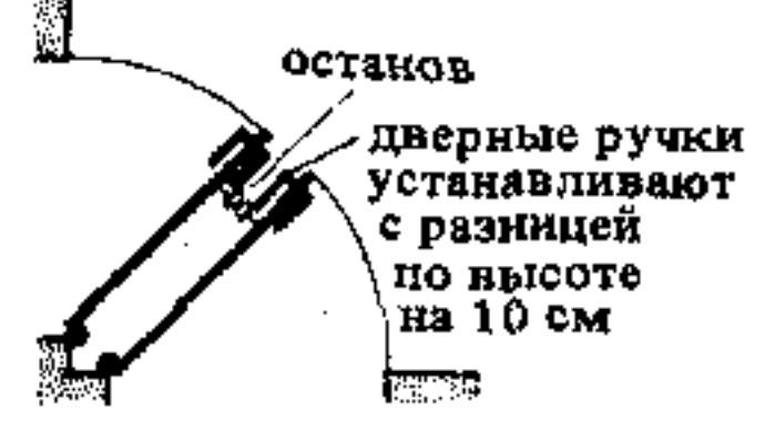
8. Правильное открывание двух дверей, ведущих в одно помещение и расположенных в углу этого помещения
