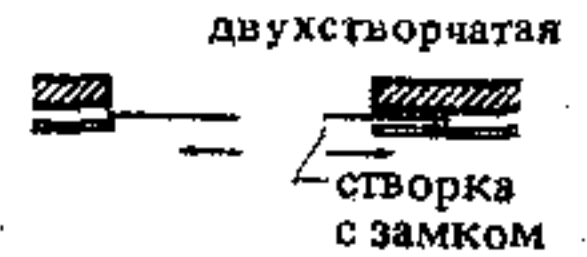
16. Раздвижная дверь, убаириющаяся внутрь перегородки
