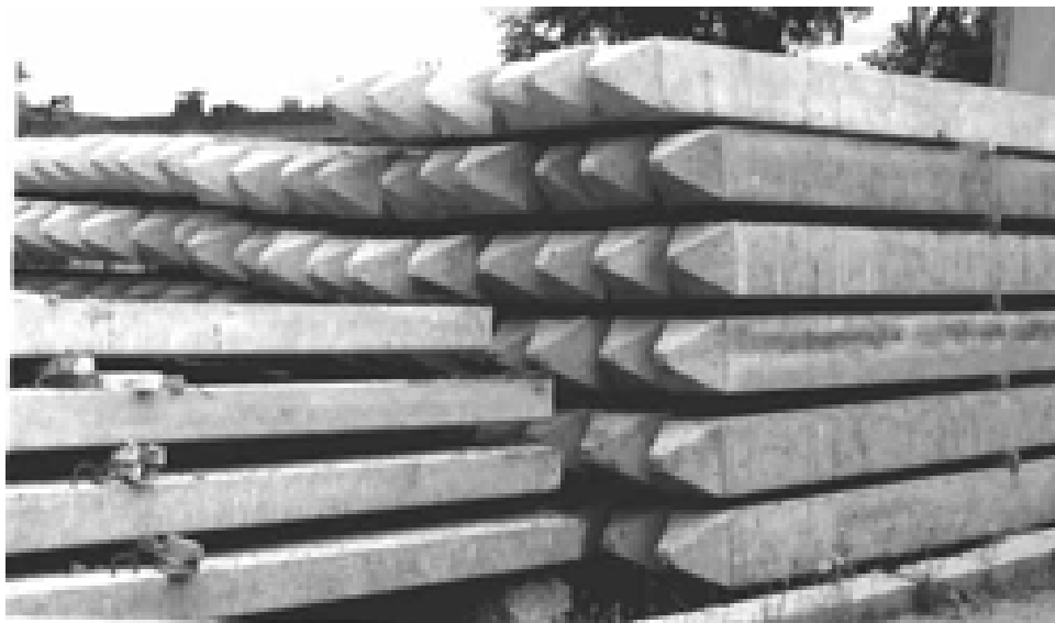
Рис. 4.6. Склаживание свай из мелкозернистого бетона.
