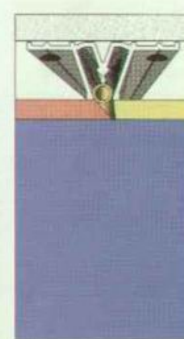
Δ Крепление двух полотен натяжного потолка через разделитель
