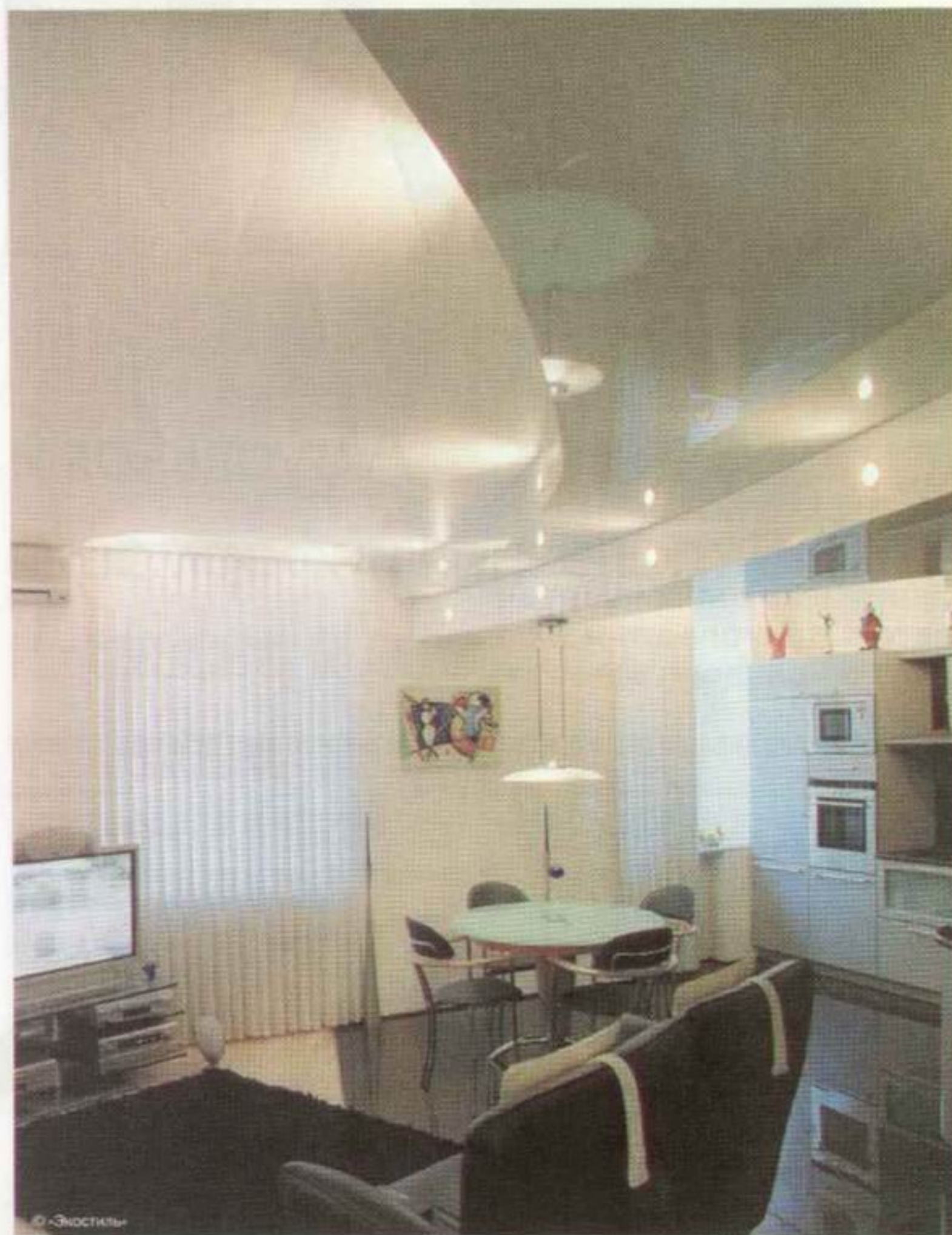
◀ «Воздушный» многоуровневый натяжной потолок скрывает массивную строительную конструкцию
