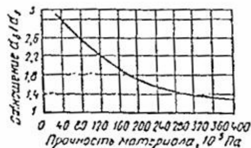
Рис. 6.10. Тарировочная кривая для определения прочности бетона молотком Кашкарова
