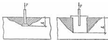
Рис. 6.13 Схема испытания методом отрыва со скалыванием при использовании анкерных устройств
