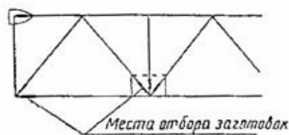
Рис. 8.6. Места отбора заготовок из элементов ферм
