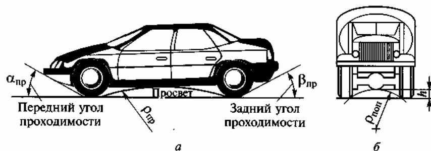
Рис. 9.1. Геометрические показатели проходимости автомобиля: а — легковой автомобиль, вид сбоку; б — грузовой автомобиль, вид спереди
