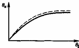
Рис. 150. График зависимости углов поворота управляемых колес
