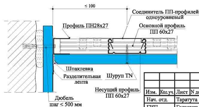
Б - Б Примыкание к стене
