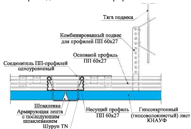
В - В Присоединение основных профилей
