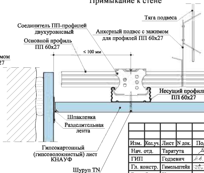
Б - Б Примыкание к стене
